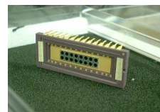
APDアレイ SPL2367 (特注品) HAMAMATSU PHOTONICS 受光面: 1.5mm、ピッチ: 2.2mm
