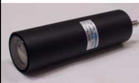
光電子増倍管 (PMT) 浜松 H3178-61 受光面 38mmφ
